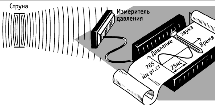
Рис. 1.2. Закон изменения звукового давления колеблющейся струны
